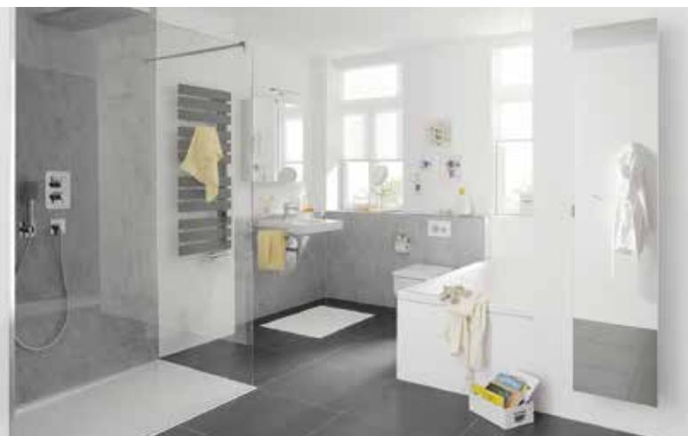
RenoDeco ist ein widerstandsfähiges, kratzfestes Aluminium-Verbundmaterial mit einer besonders pflegeleichten Oberfläche. Diese macht es zu einem idealen Wandbelag für Nassbereiche wie der Dusche – ebenso wie hinter Waschtisch und WC.
