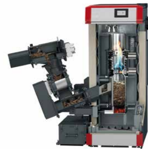
Der Kessel verbrennt so sauber, dass er ohne Partikelfilter auskommt. Er ist absolut dicht, sodass das Glutbett bis zu vier Tage erhalten bleibt, das spart bis zu 90% Zündenergie.
